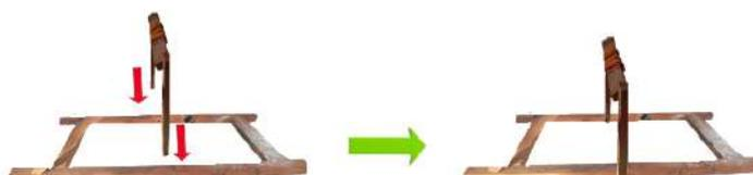
5- Pregar os dois pedaços de barrote de 54cm, um em cada lado ligando a extremidade superior da estrutura semelhante uma trave de campo de futebol com a base, exatamente a distância que pregamos inicialmente o pedaço de 50cm a 30cm da extremidade. Essa estrutura irá reforçar a base da catapulta para suportar a força aplicada.
