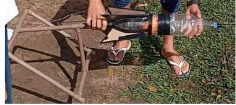
5. Virar a base rápido para cima, para que a bexiga caia na ponta da lança e estoure. Em seguida dar duas agitadas na base com a garrafa para que a ação química potencialize.
