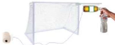
7- Colocar uma câmera filmando para ter precisão do tempo inicial e final. Em seguida o professor deve acionar o foguete colocando fogo na ponta do barbante a uma distância de 3m que funcionará como um pavio;
