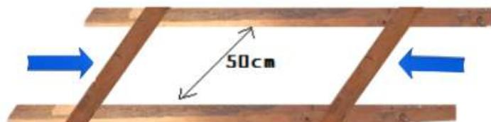
3-Com os outros 3 pedaços de barrote de 50cm de comprimento, colocar dois em paralelo a uma distância de 50cm e pregar o terceiro nas extremidades deles, formando assim uma estrutura semelhante uma trave de campo de futebol.
