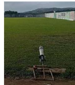
6. Rapidamente colocar a base no chão, travá-la com os grampos, se afastar os 6m e fazer uma contagem regressiva para que o foguete pegue pressão e puxar o cordão para destravar o foguete.
