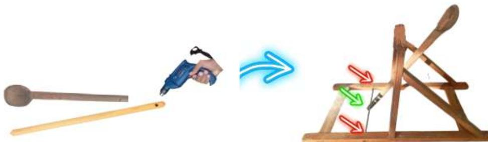
8- se for usar o cabo de vassoura usar a altura do braço da catapulta e cortar o cabo da vassoura na altura desejada. Cortar a garrafa pet e fazer uma concha e encaixar na extremidade do braço da catapulta (cabo de vassoura).
